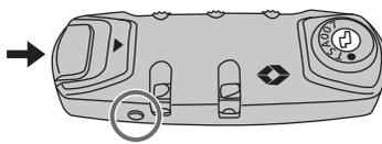
4. セットしたダイヤルの番号が動かないように注意しながら、スライドボタンを動かしてください。「カチッ」と音がして、ダイヤルチェンジボタンが押し込まれていない状態に戻ります。これでセット完了です。
